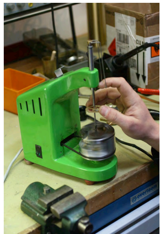
Afbeelding 3. De tappenpolijstmachine in actie, het rad wordt met de hand stilgehouden terwijl de draaibare polijstkop van de machine om de tap draait. Met de wijsvinger wordt het tegencentrum naar beneden gedrukt.
