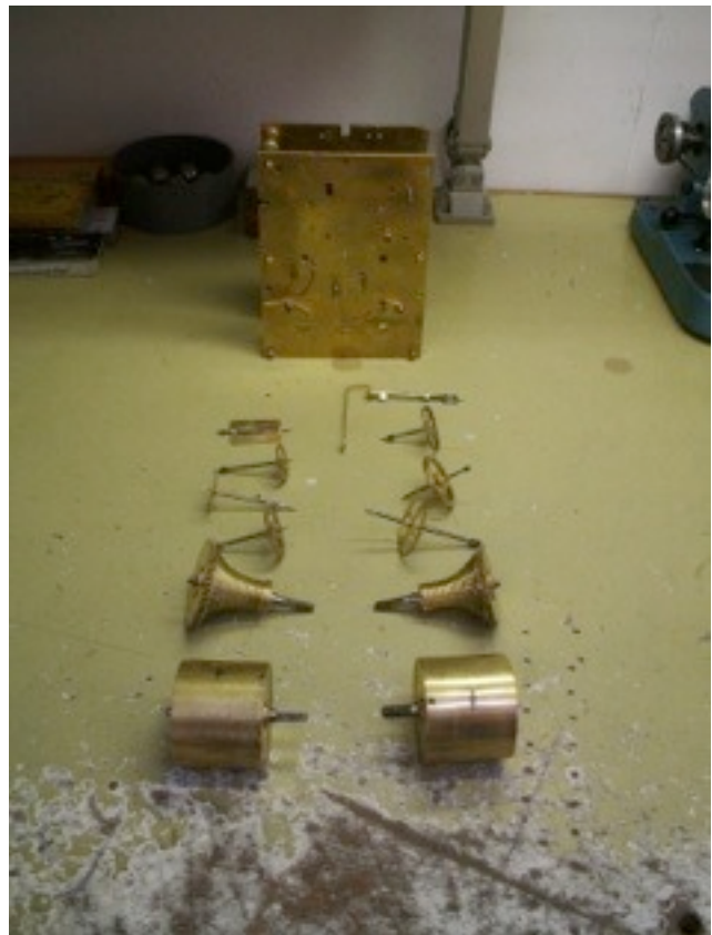
De platines van het uurwerk met daaronder links de raderen en veerton van het slagwerk en rechts de raderen en veerton van het gaandwerk.
