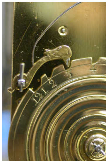
Afb. 5. De Sluitschijflichter heeft de vorm van een vogelkop. De sluitschijf heeft een gegolft oppervlak wat doet denken aan water. Tijdens het slaan gaat de lichter op en neer net zo lang tot de lichter een inkeping in de sluitschijf tegenkomt.
