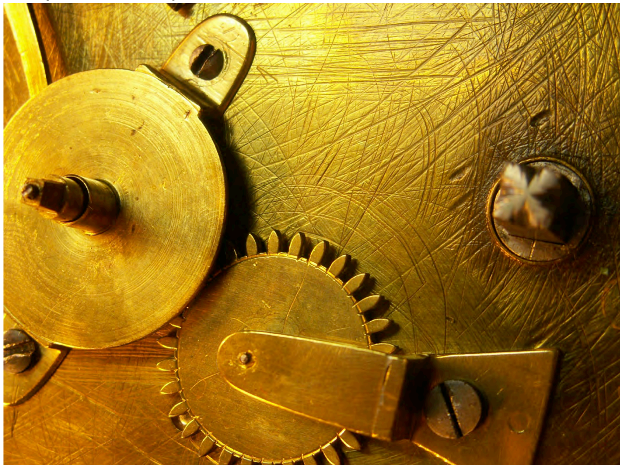
Afb. 18. Het wisselrad en de afdekplaat van het minutenrad. Ook goed zichtbaar is de matige afwerking van de platine aan de voorzijde van het uurwerk.
