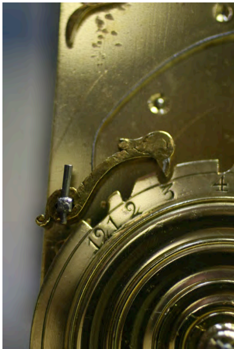
Afb. 23 en 24. De stuit en voorslaglichter, links staat het slagwerk op normale wijze geblokkeerd rechts staat het slagwerk op voorslag. Door de stuiting en voorslag op 1 rad te plaatsen is de hoeveelheid voorslag een vast gegeven.
