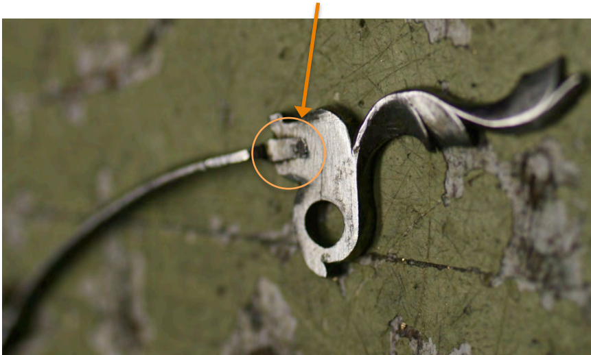
Afb. 3. De sluitschijflichterveer met de eerder gerepareerde veer, als de soldering wat minder zichtbaar was geweest was het een goede reparatie.
