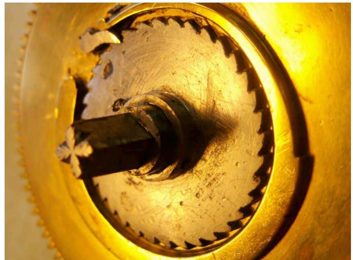
Afb. 15. Het palrad met de palveer en pal en het fraai bewerkte opwindvierkant
