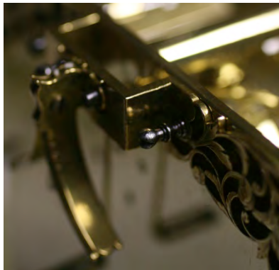
Afb. 7. Te zien is de slingerophanging met de bijgemaakte schroef.
