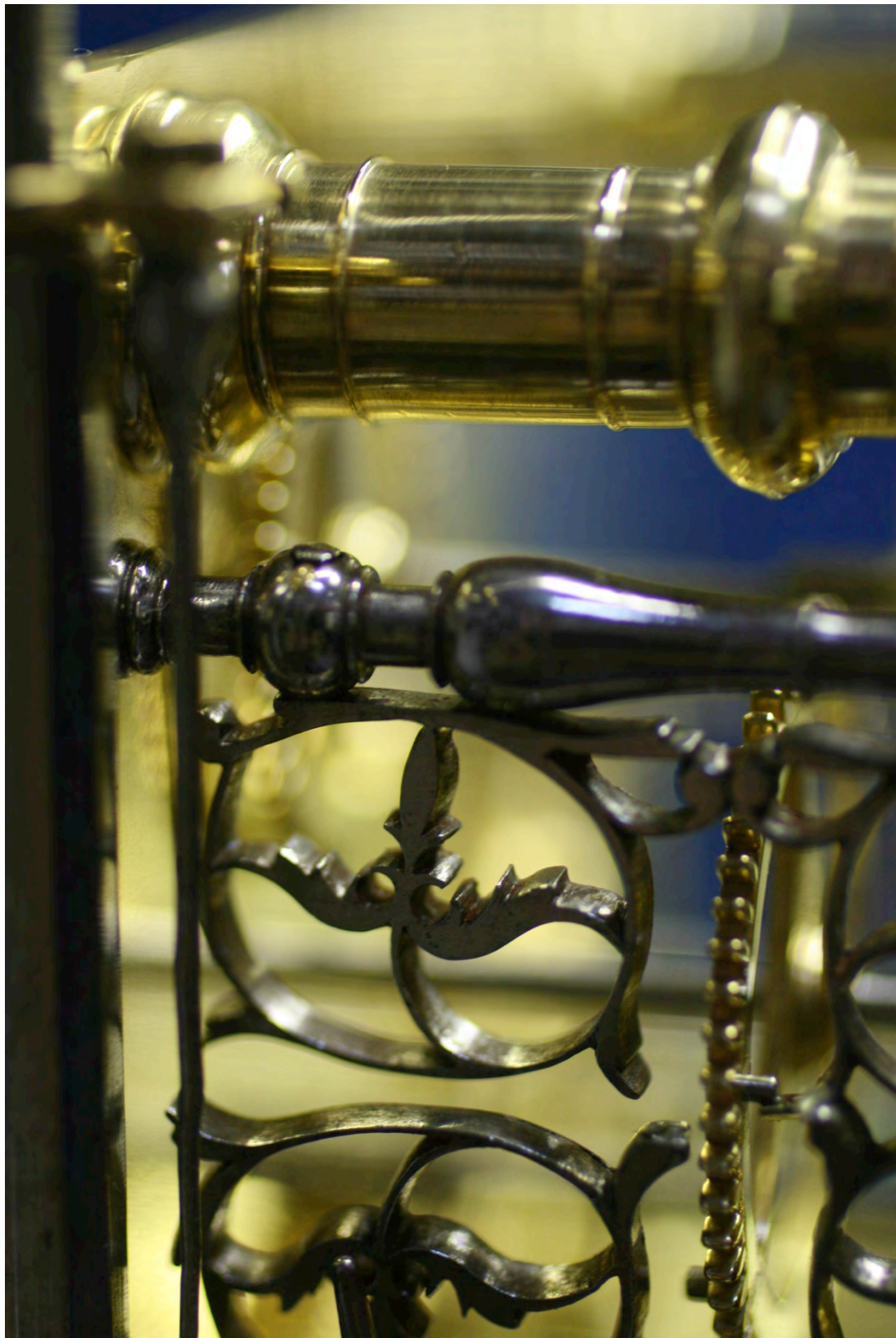
Afb. 22. Detailopname van de pilaar en de lichters van het slagwerk, de balustervormen zijn ook hier bijzonder fraai gemaakt en gepolijst, dit moet een zeer tijdrovende klus geweest zijn om te vervaardigen.
