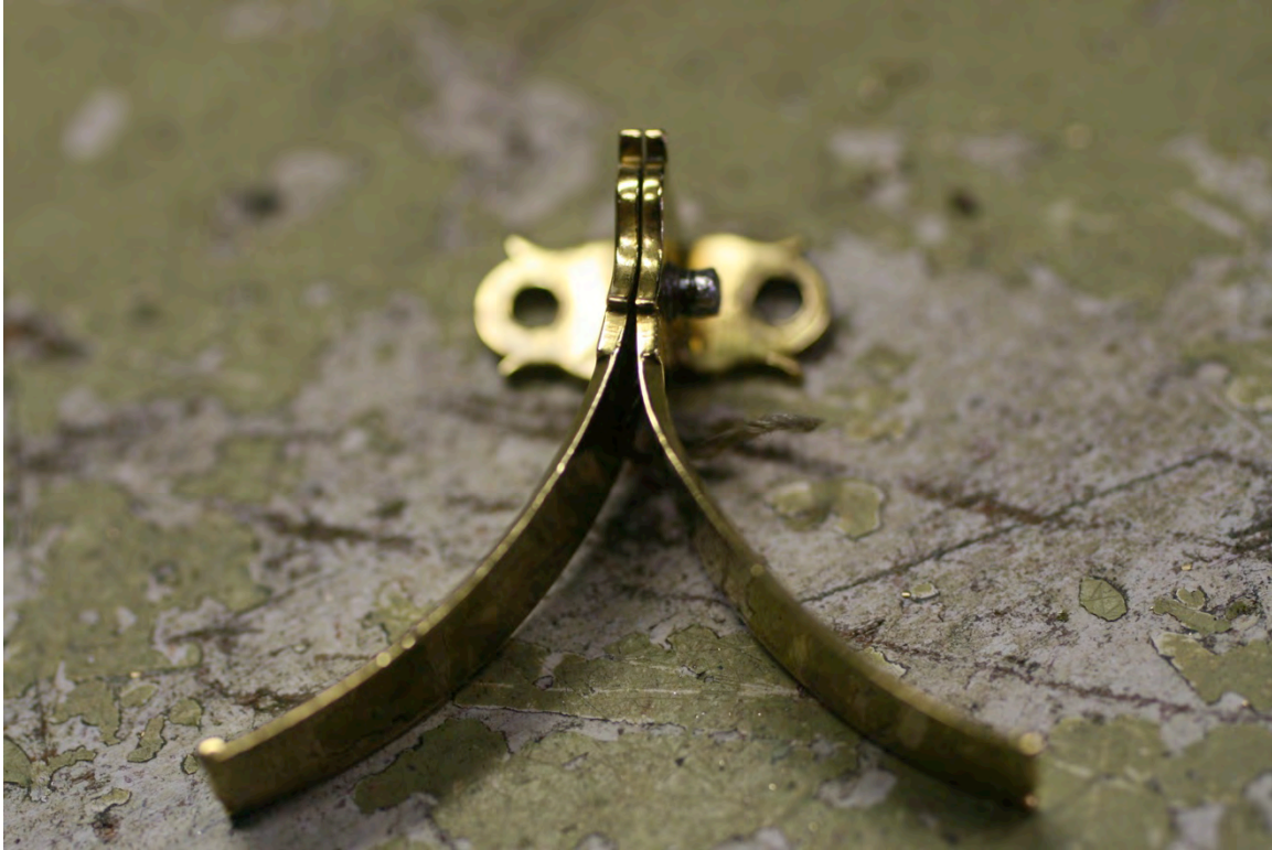
Afb. 31. De boogjes van Huygens welke ook het koordje van de slinger vastklemmen.
